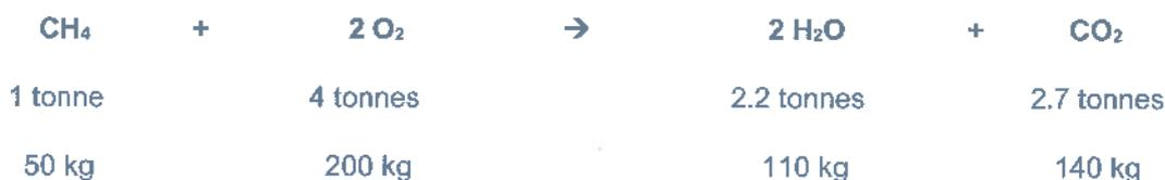
La quantité de gaz naturel nécessaire à la cuisson d'une tonne de Chaux étant de l'ordre de 50Kg, la quantité de CO<sub>2</sub> émise par la réaction de combustion est donc de l'ordre de 25% (140/560) du poids de chaux.
